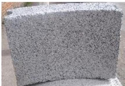
**Fig. 7.** Bloque macizo curvo de hormigón.
