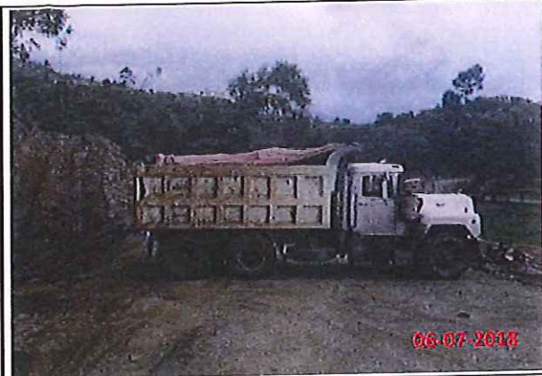
Uso de lonas en volquetas para evitar caída de material
