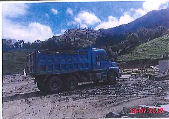
Uso de lonas en volquetas para evitar caída de material
