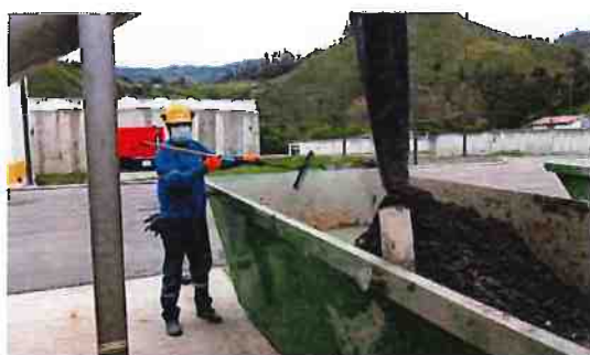
Nivelación de las arenas en los contenedores
