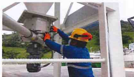
Revisión parte de alimentación de cal
