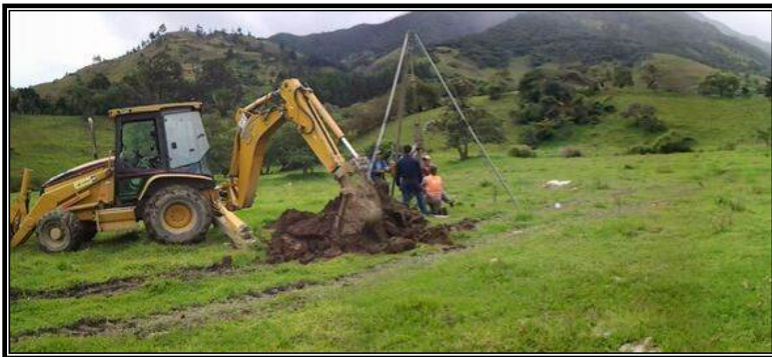
PENETRACIÓN ESTÁNDAR EN LA CALICATA N° 8 - FOTO N° 17
