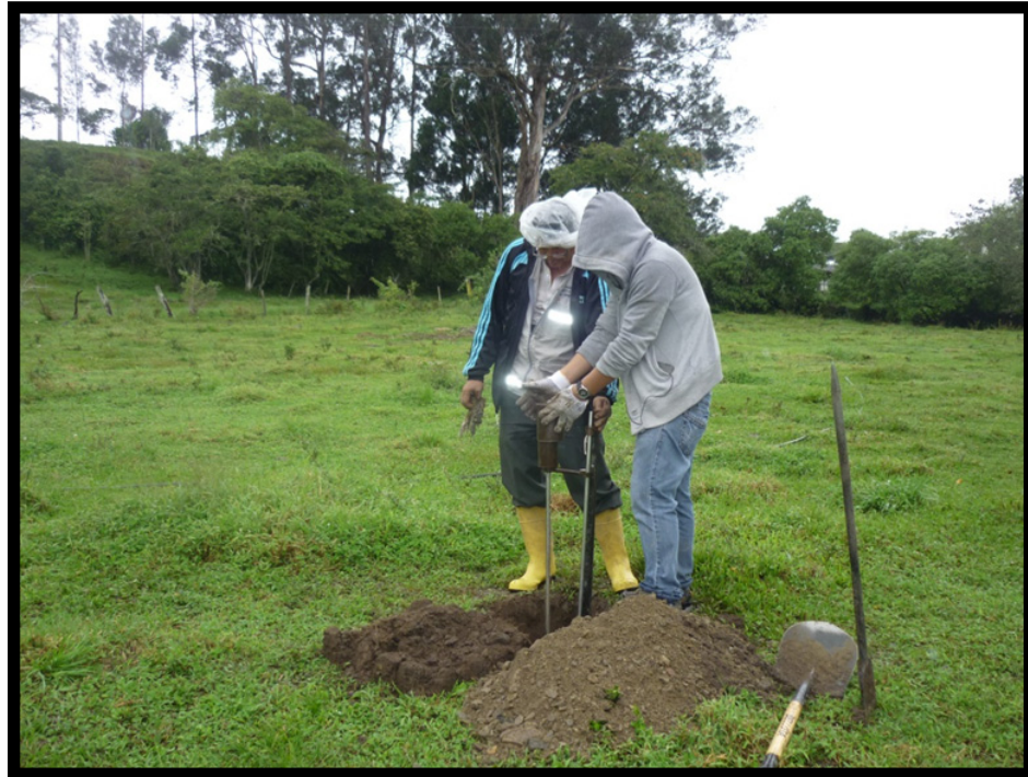
ENSAYO IN SITU CON EL EQUIPO DE DCP PARA DETERMINAR EL CBR PERFORACIÓN N° 20 - FOTO N° 36
