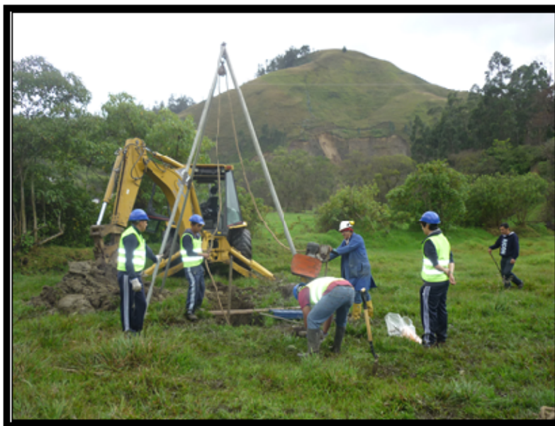
PENETRACIÓN ESTÁNDAR EN LA CALICATA N° 13 - FOTO N° 28 PRESENCIA DEL NIVEL FREÁTICO A 1.0 METRO.
