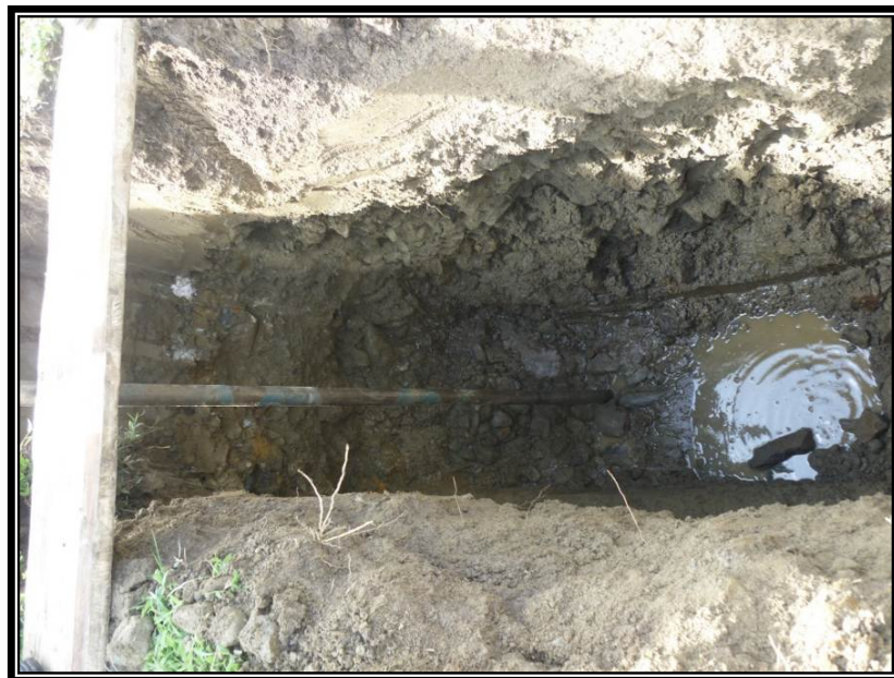
MATERIAL GRANULAR, PRESENCIA DE NIVEL FREÁTICO A 1,7 M EN LA CALICATA Nº 3 FOTO - Nº 8
