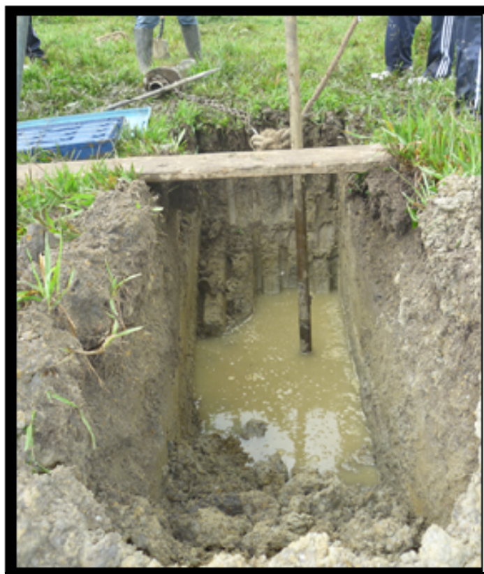
PENETRACIÓN ESTÁNDAR EN LA CALICATA N° 13 - FOTO N° 28 PRESENCIA DEL NIVEL FREÁTICO A 1.0 METRO.
