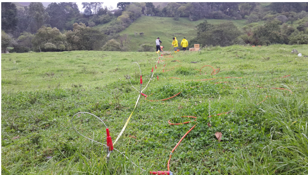
Foto 19. Arreglo eléctrico para tomografía eléctrica por IP (polarización inducida).
