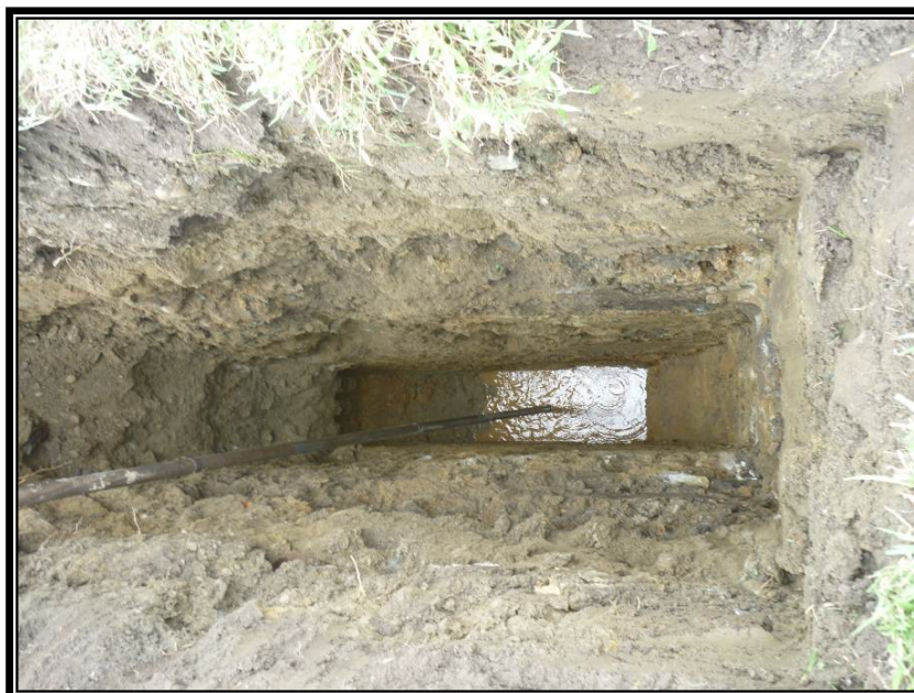
PRESENCIA DE NIVEL FREÁTICO A 4 M EN LA CALICATA N° 9 FOTO N° 20
