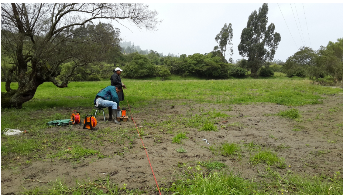
Foto 18. SEV 10 con el Equipo Terrameter System, en la terraza media.
