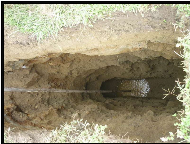
PRESENCIA DE NIVEL FREÁTICO A 4 M EN LA CALICATA N° 11 - FOTO N° 24
