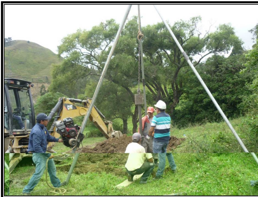
PENETRACIÓN ESTÁNDAR EN LA CALICATA N° 4 - FOTO N° 9
