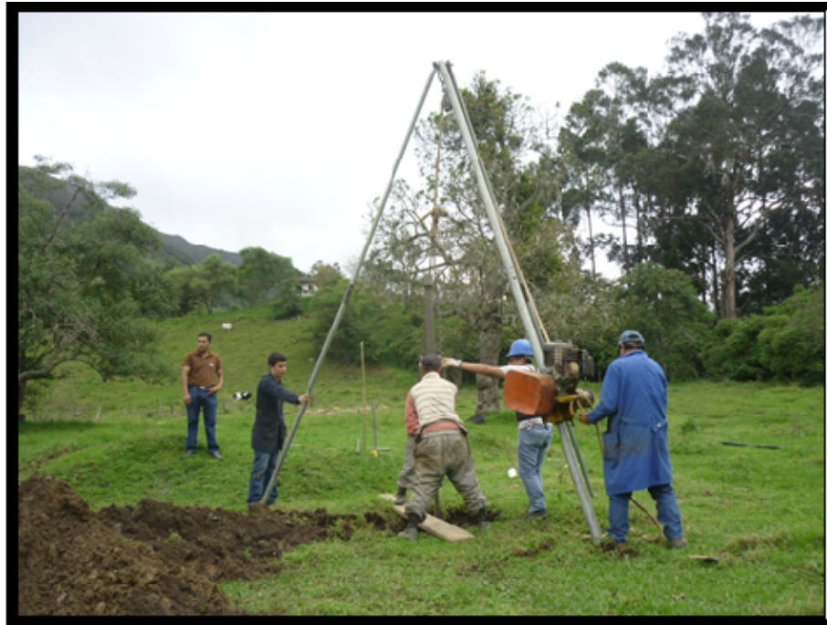
PENETRACIÓN ESTÁNDAR EN LA CALICATA N° 9 - FOTO N° 19
