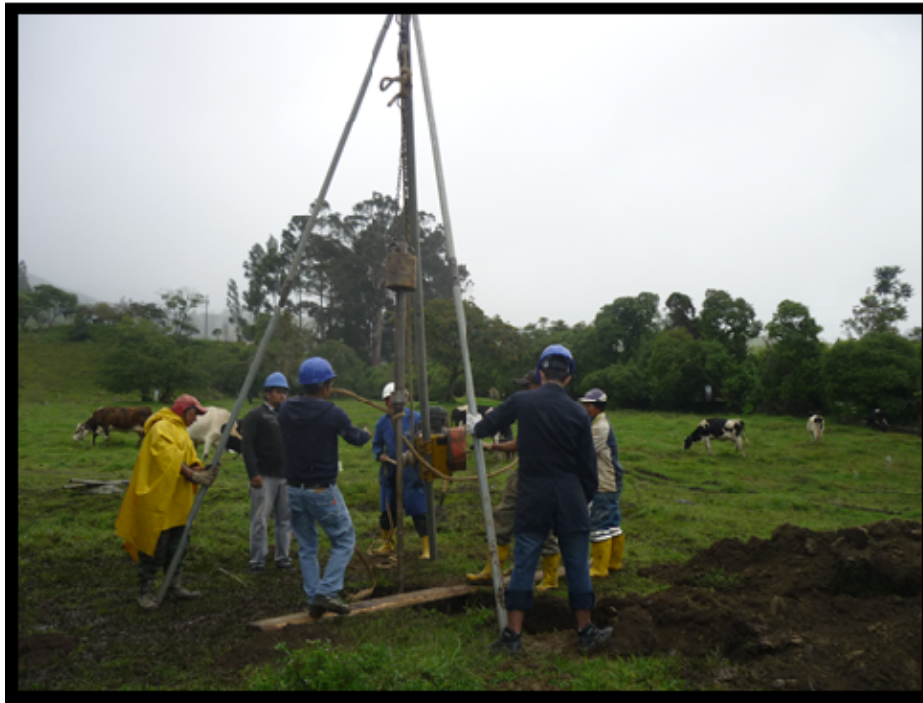
PENETRACIÓN ESTÁNDAR EN LA CALICATA N° 10 - FOTO N° 21
