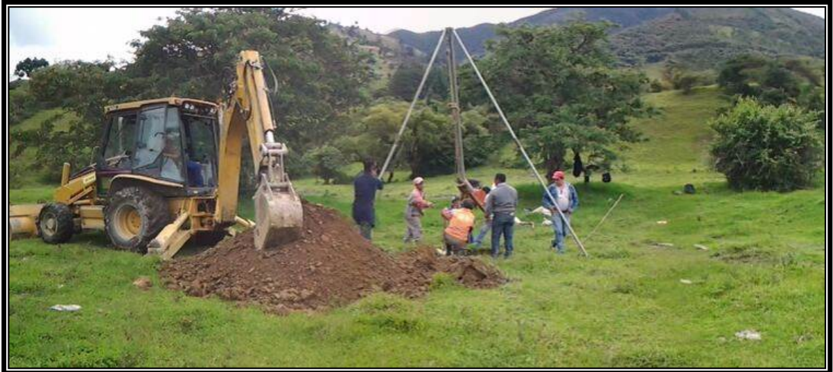
PENETRACIÓN ESTÁNDAR EN LA CALICATA N° 7 FOTO - N° 15
