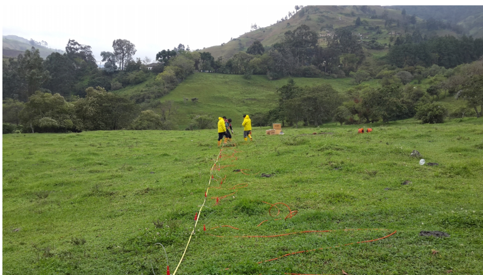
Foto 20. Arreglo eléctrico para tomografía eléctrica por IP (polarización inducida).
