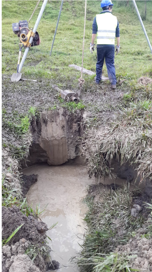
Foto 6. Calicata C#13 colapsada luego de la excavación, el nivel freático está a 1m de profundidad (foto 19-06-2015).
