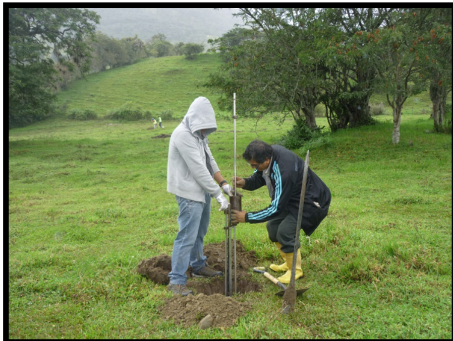
ENSAYO IN SITU CON EL EQUIPO DE DCP PARA DETERMINAR EL CBR PERFORACIÓN N° 20 - FOTO N° 36
