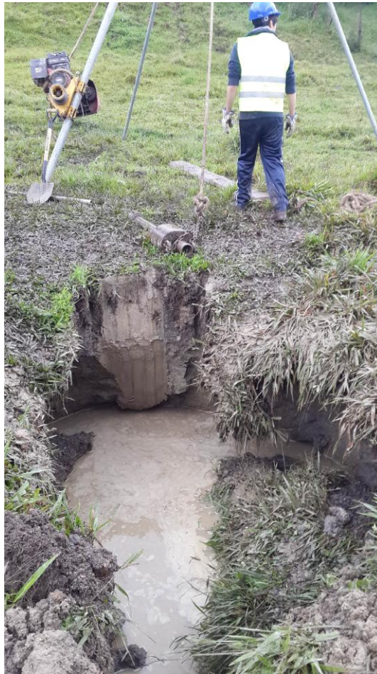
Foto 5. Calicata C#13 colapsada luego de la excavación, el nivel freático está a 1m de profundidad (foto 19-06-2015).
