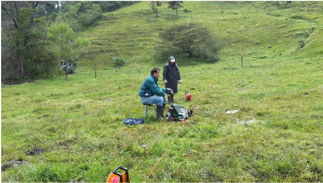
Foto 16. SEV 9 con el Equipo Terrameter System, al fondo el deslizamiento activo
