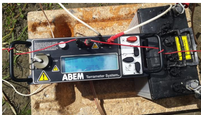
Foto 14. Equipo Terrameter System utilizado para el estudio geofísico
