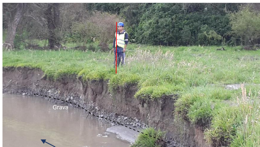
Foto 3. Margen derecho terraza media, nótase la capa de limo y arena de 1.00m de espesor, más abajo gravas grises
