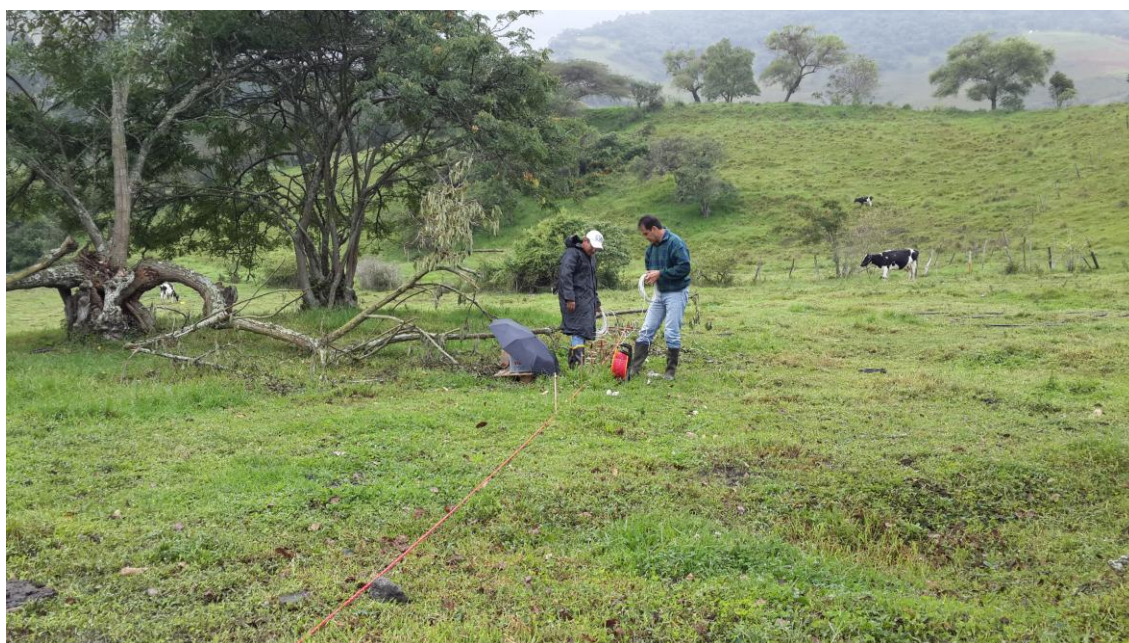
Foto 15. Jornada de campo con el Equipo Terrameter System utilizado para el estudio geofísico
