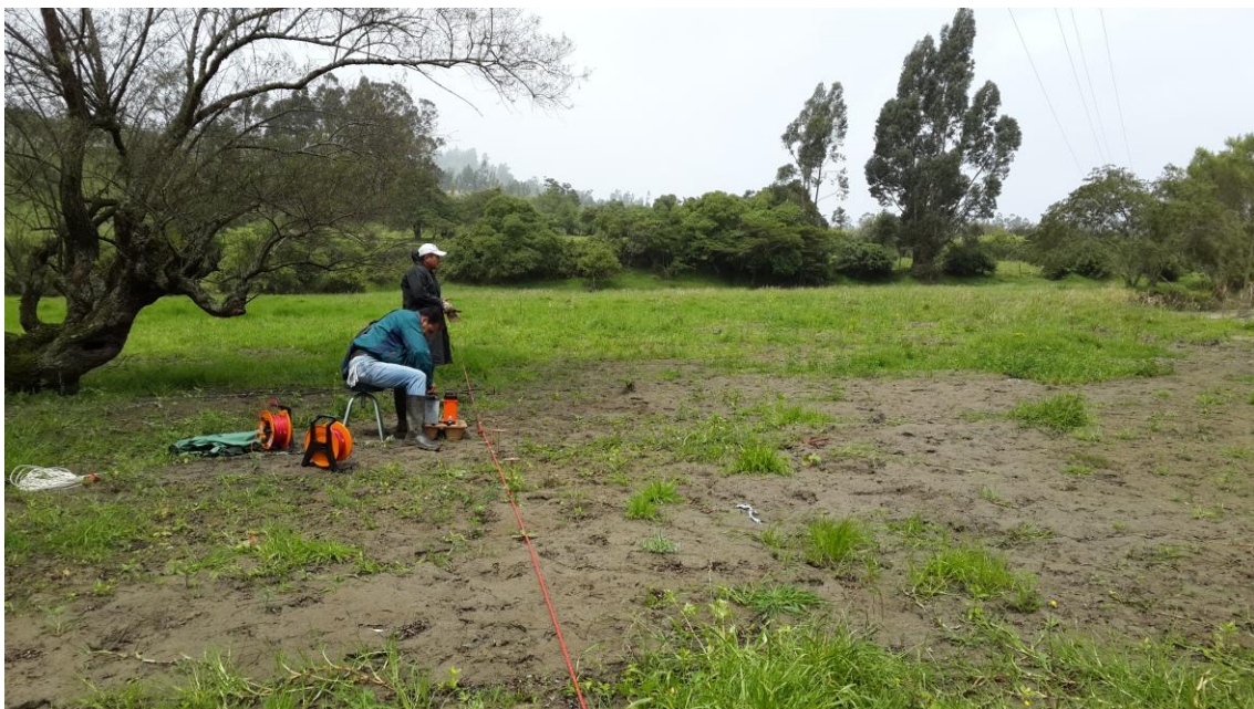
Foto 17. SEV 10 con el Equipo Terrameter System, en la terraza media.
