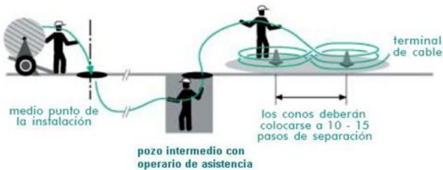
Fig. 3. Tendido entre tramos de cable de fibra óptica.
