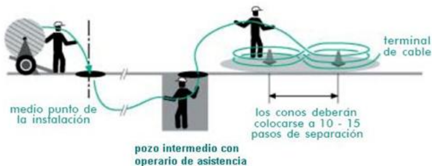
Fig. 1. Tendido entre tramos de cable de fibra óptica.
