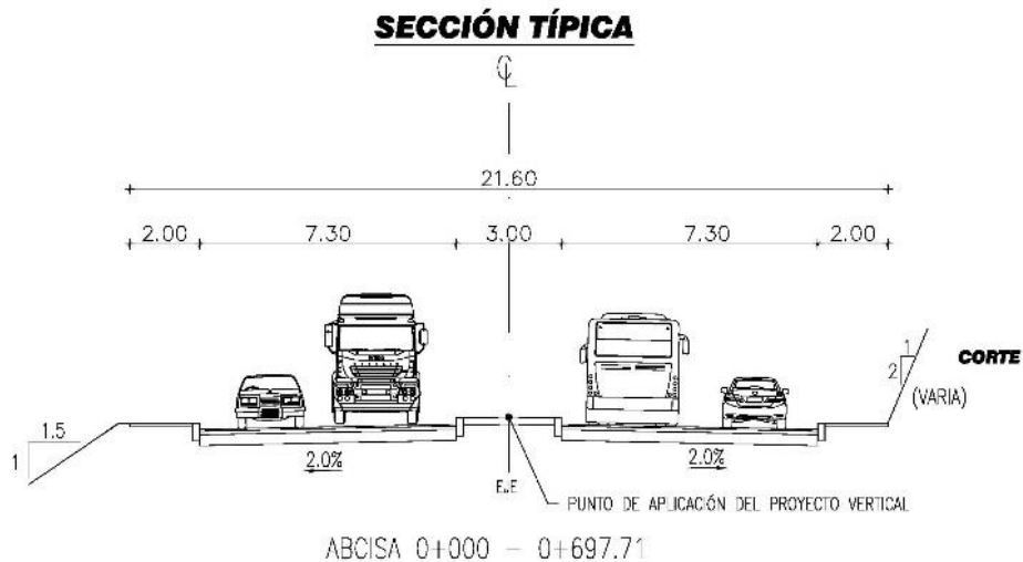
Figura 50. Sección Típica en zona consolidada
