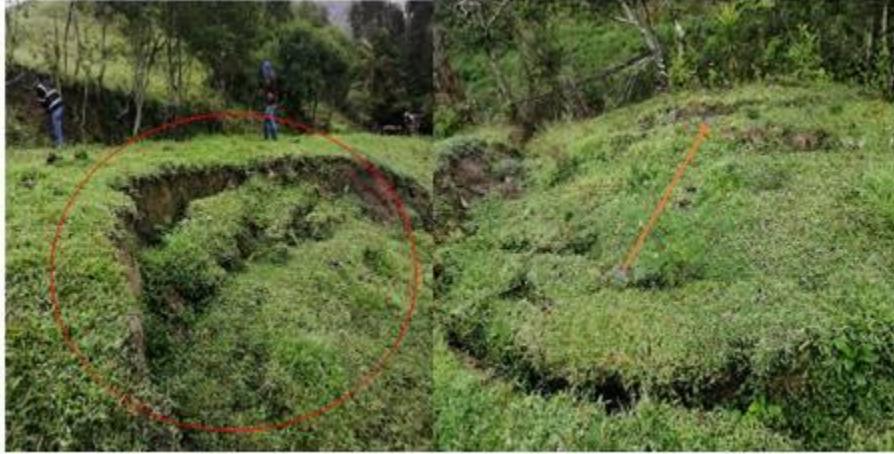
Figura 132. Microdeslizamientos, Abs. 2+500, Coordenadas WGS84: 700387, 9552922.
