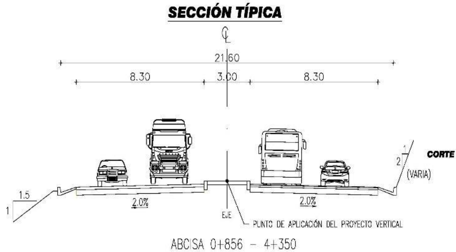
Figura 51. Sección Típica en zona no consolidada
