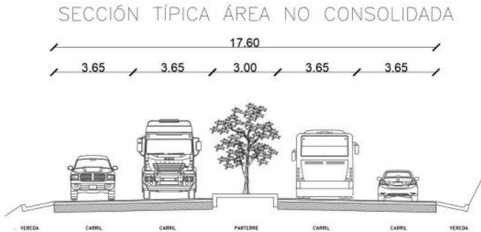
Figura 6. Sección Típica Km 0+856 al Km 4+350
