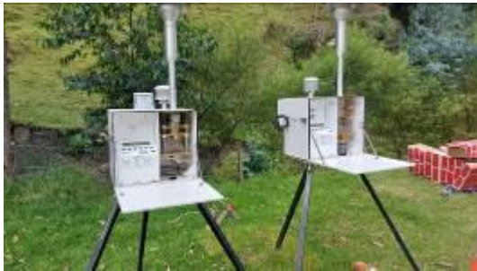
Figura 72. Colocación de equipos de monitoreo para ruido y material particulado PM 10 y PM 2.5
