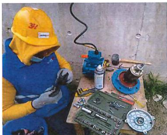
MANTENIMIENTO MOTORES DECANTADORES
