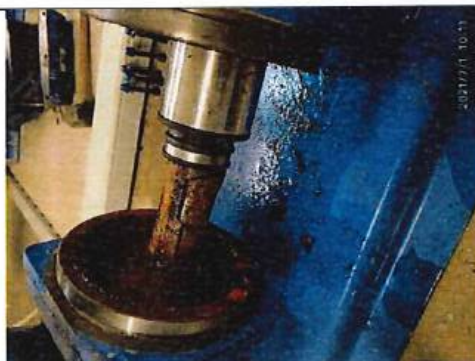
Limpieza del rotor de las bomba de tornillo
