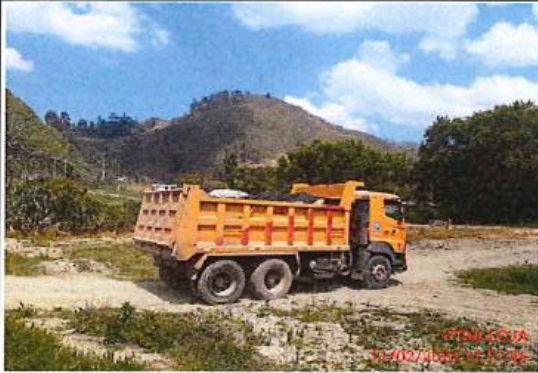
COLOCACIÓN DE LONA EN VOLQUETAS PARA EVITAR CAIDA DE MATERIAL TRANSPORTE CANTERA-OBRA
