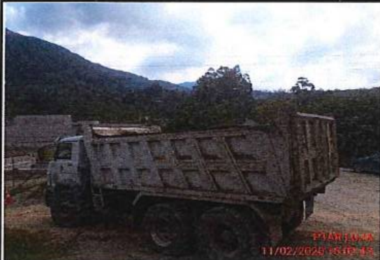
COLOCACIÓN DE LONA EN VOLQUETAS PARA EVITAR CAIDA DE MATERIAL TRANSPORTE CANTERA-OBRA
