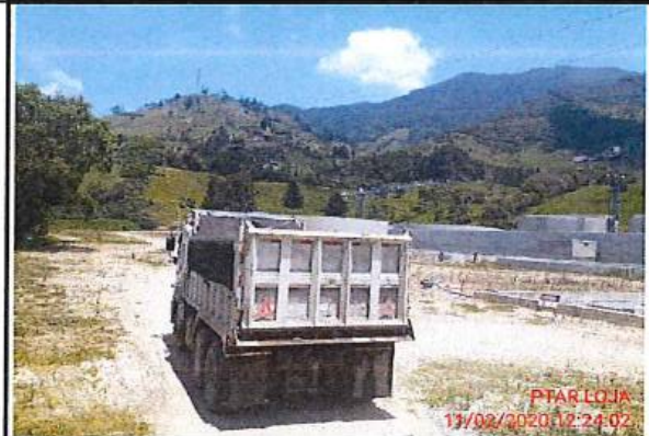
COLOCACIÓN DE LONA EN VOLQUETAS PARA EVITAR CAIDA DE MATERIAL TRANSPORTE CANTERA-OBRA
