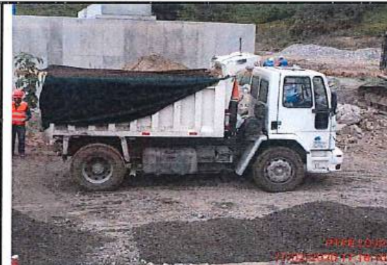
COLOCACIÓN DE LONA EN VOLQUETAS PARA EVITAR CAIDA DE MATERIAL TRANSPORTE CANTERA-OBRA
